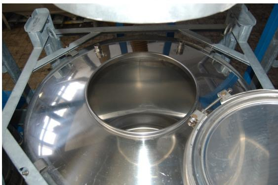
**Bild 4** Mit Raster-Clean gereinigter Behälter
