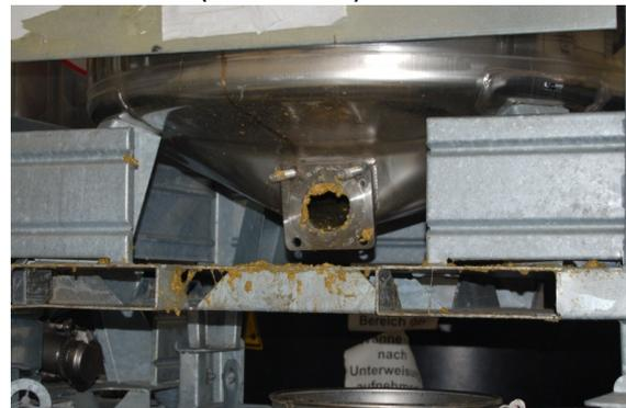
**Bild 2** Mit Klebstoffen verschmutzter Edelstahl IBC
