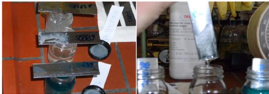
**Bild 3** Ausgehärtete Phenol-/Epoxidharze nach 10 min Einwirkzeit (40°C)
