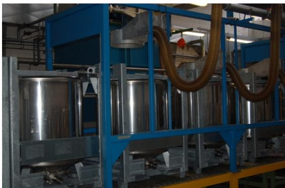
**Bild 1** Lösemittel Reinigungsanlage (V2A)
